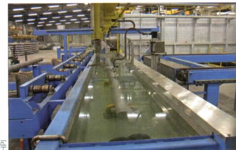
Ultraschallprüfanlage mit Durchlaufhomogenisierungs-ofen im Hintergrund
