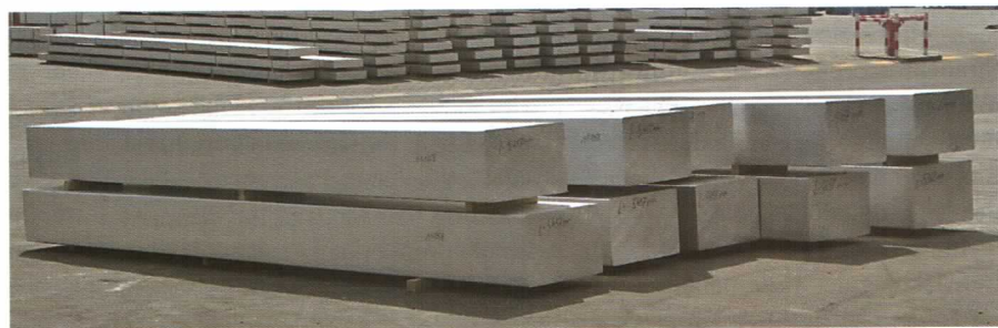
Durch horizontalen Strangguss hergestellte Barren
